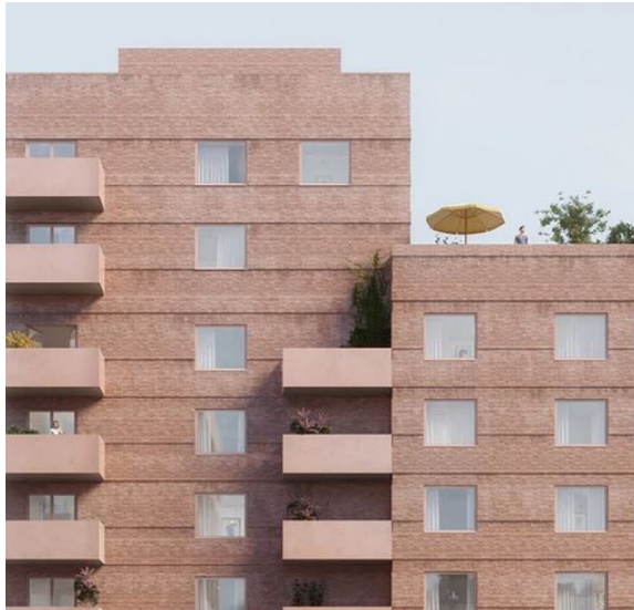
Fasaden utformas med kvadratiske fönster och tegelband i varierande murning
